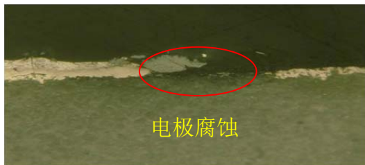
图 2 左端正电极被腐蚀现象图
