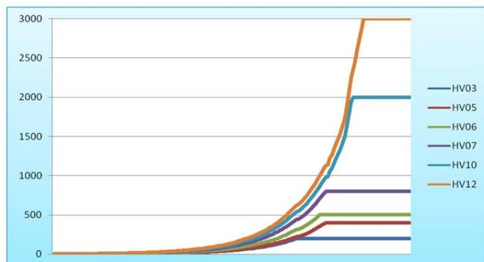
說明：以大尺寸為例，普通產品的 2512 最大工作電壓為 200V，對應的臨界阻值是 40K；而 HV12 的最大工作電壓（3000V）對應阻值為 9M $\Omega$ 。此時，高阻的 HV 產品優勢就盡顯無疑，相對低阻的高壓則是沒有意義的。
