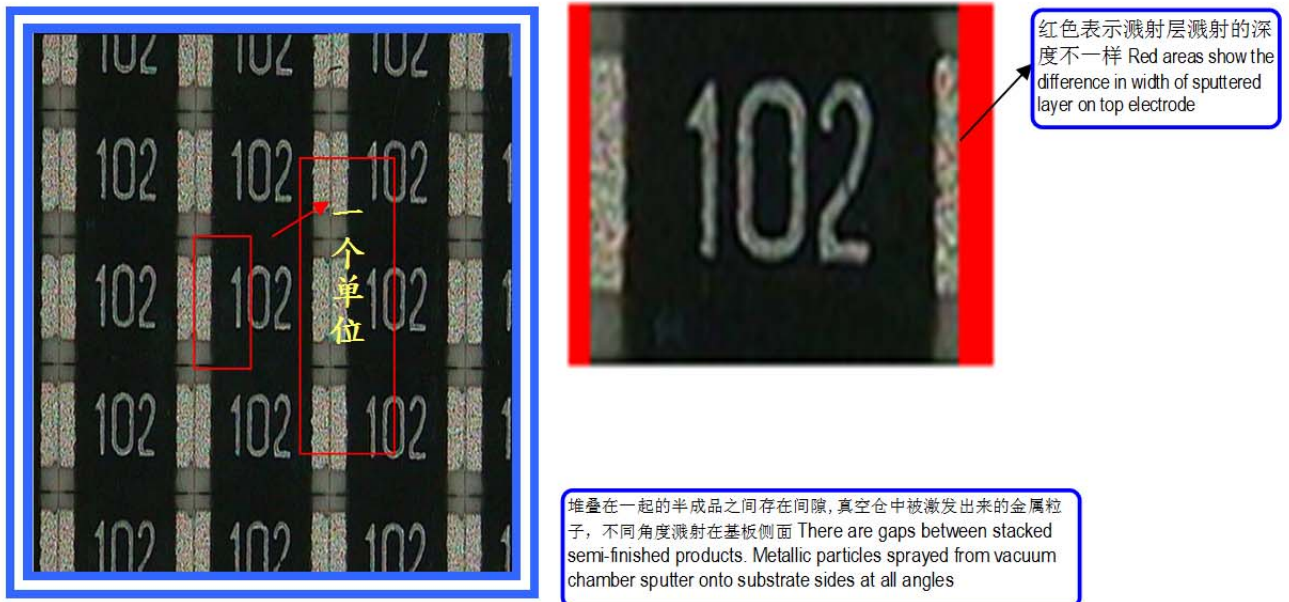
图 8 真空溅射前图示 Pic 8 before vacuum sputtering
