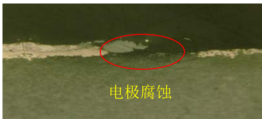
图 1 左端正电极被腐蚀现象图
