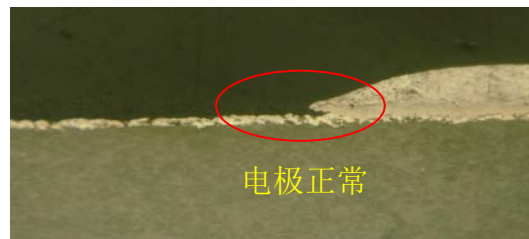
2 右端正电极正常情形
