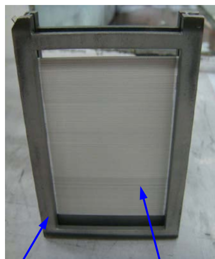
条状半成品堆叠，在仓夹中溅射侧电极
