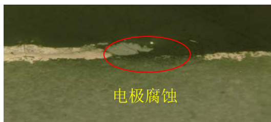
图 1 左端正电极被腐蚀现象图
