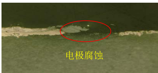
图 1 左端正电极被腐蚀现象图
